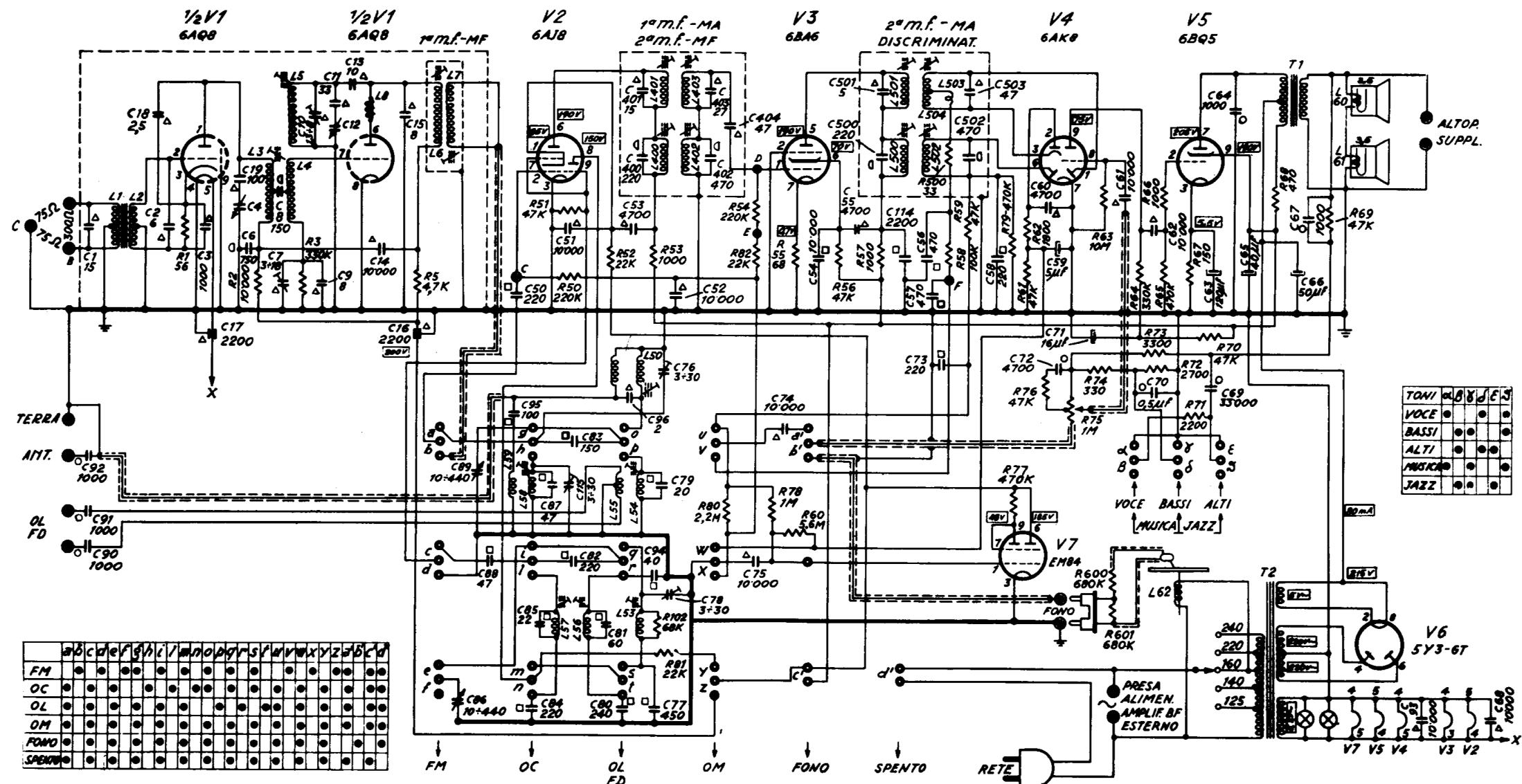
Le misure di tensione si intendono effettuate tra il punto indicato e la massa con voltmetro da 20.000  $\Omega/\text{v}$ .
